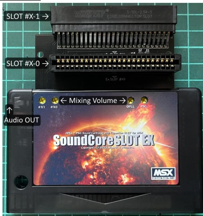
外部スロットに逆挿し防止機構はありません。スロット#X-0 は▽方向がカートリッジの正面になるように挿入してください。逆挿しは故障の原因になります。
