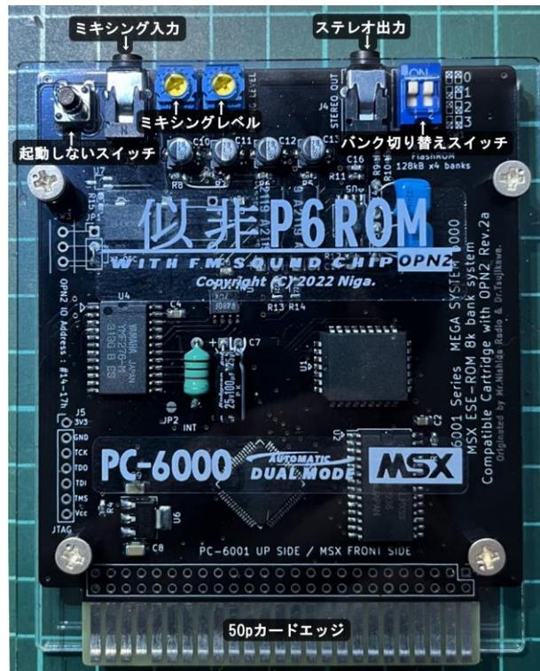
本機の製品名が表示された面を、通常のカートリッジのラベル面として P6 または MSX のスロットに挿入してください。本機に逆挿し防止機構はありません。特に本体の前面にスロットがレイアウトされている MSX では間違えやすいのでご注意ください。
