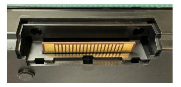
拡張端子の接点には手を触れないようにしてくださ い。皮脂が付着すると腐食の原因になります。
