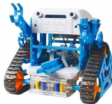
キットはタミヤのカムプログラムロボット等のキャタピラタイプ左右2モーター仕様のものを想定しています。ステアリング操作タイプのキットには使用できません。
