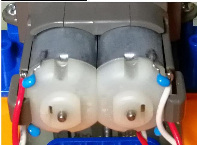
ノイズ対策としてモーターの各電極と金属ケース間に  $0.1\mu\text{F}$  程度のコンデンサを半田付けしてください。モーター1個につきコンデンサが2個必要です。金属ケースは半田付け面を軽くヤスリで擦っておくと半田のノリがよくなります。
